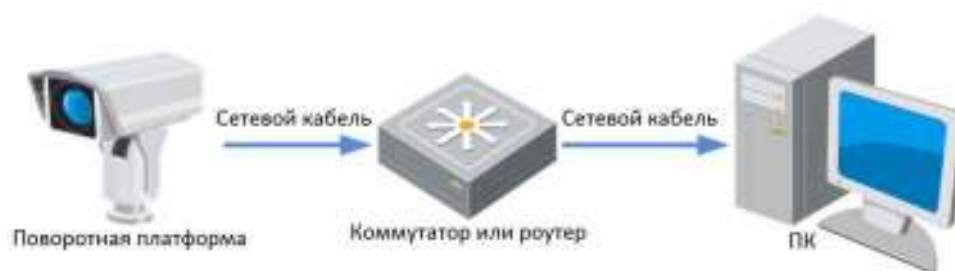
Рисунок 2-2 Подключение через коммутатор или роутер
