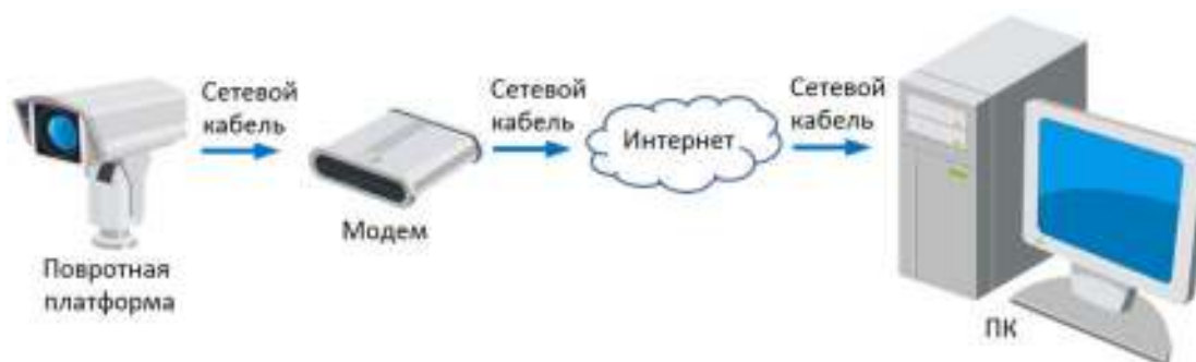
Рисунок 2-12 Доступ к поворотной платформе с динамическим IP-адресом
