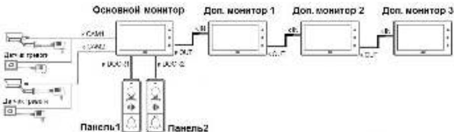
Вызывные панели подключаются только к основному монитору.
