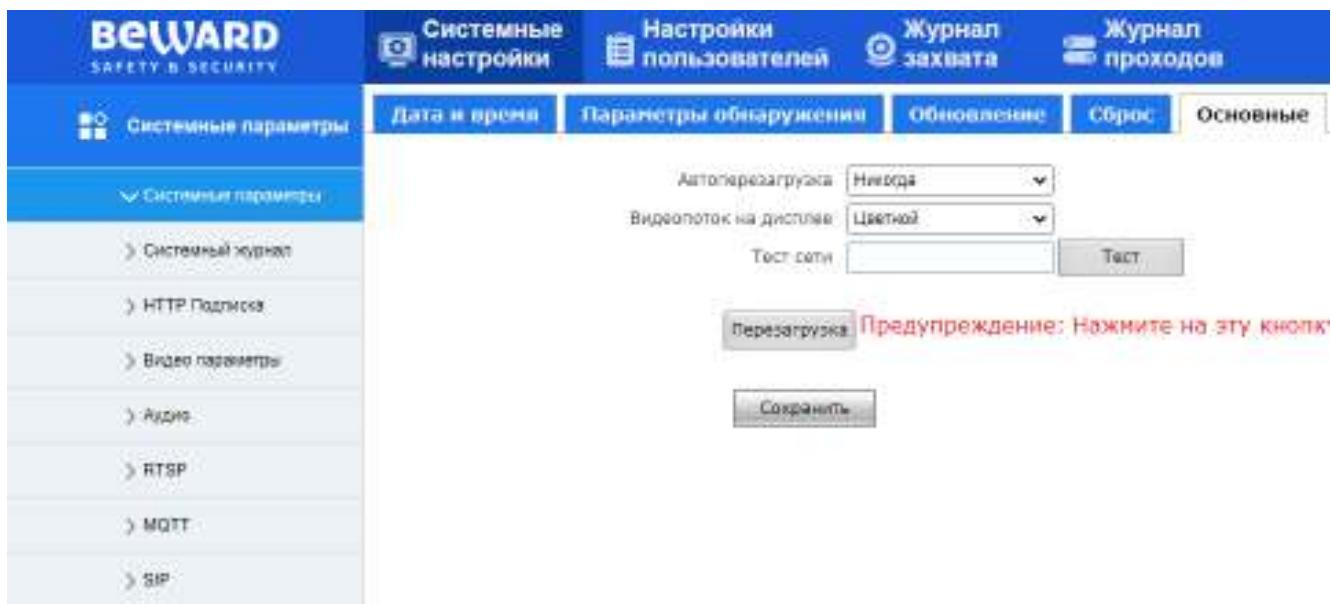
**[Автоперезагрузка]** (по-умолчанию: никогда). Установка дня и часа выполнения автоматической перезагрузки устройства. Возможно выполнять перезагрузку раз в неделю, либо ежедневно в начале выбранного часа.
