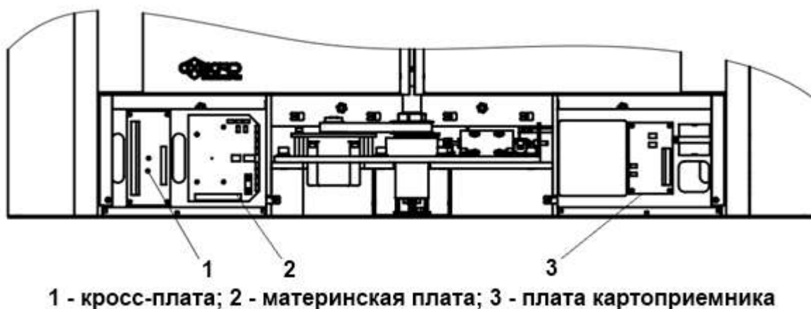
Рисунок 4 – Расположение плат на стойке модуля турникета
