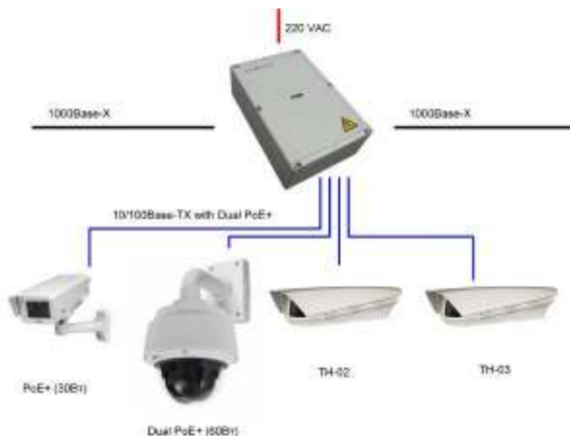
Рис. 1. Схема подключения PSW-2G+
