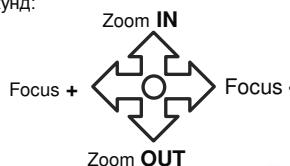
Управление моторизованным объективом осуществляется джойстиком, а также по коаксиальному кабелю через функцию UTC видеорегистратора.
