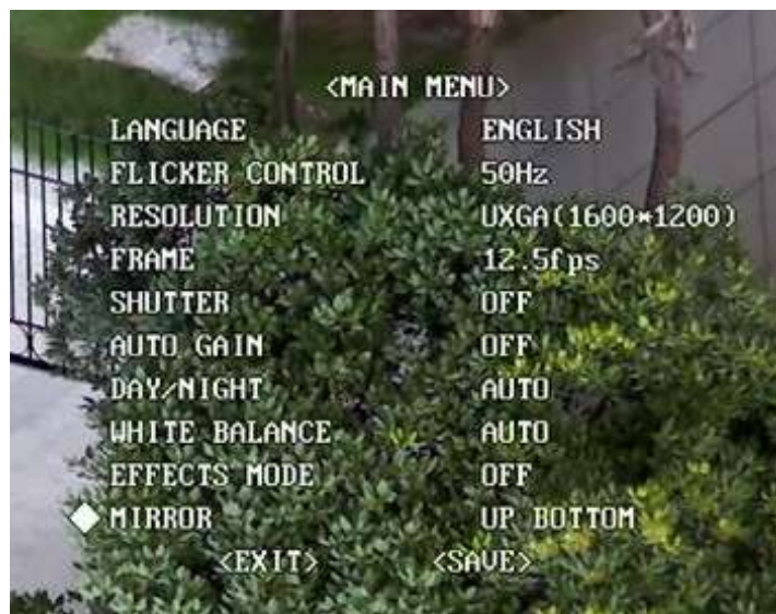
Включенный режим зеркалирования в положении UP BOTTOM (СВЕРХУ ВНИЗ)
