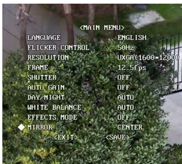
Включенный режим зеркалирования в положении CENTER (ОТ ЦЕНТРА)
