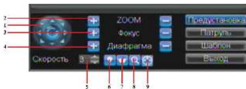
Рис. 3. Интерфейс управления устройствами PTZ
