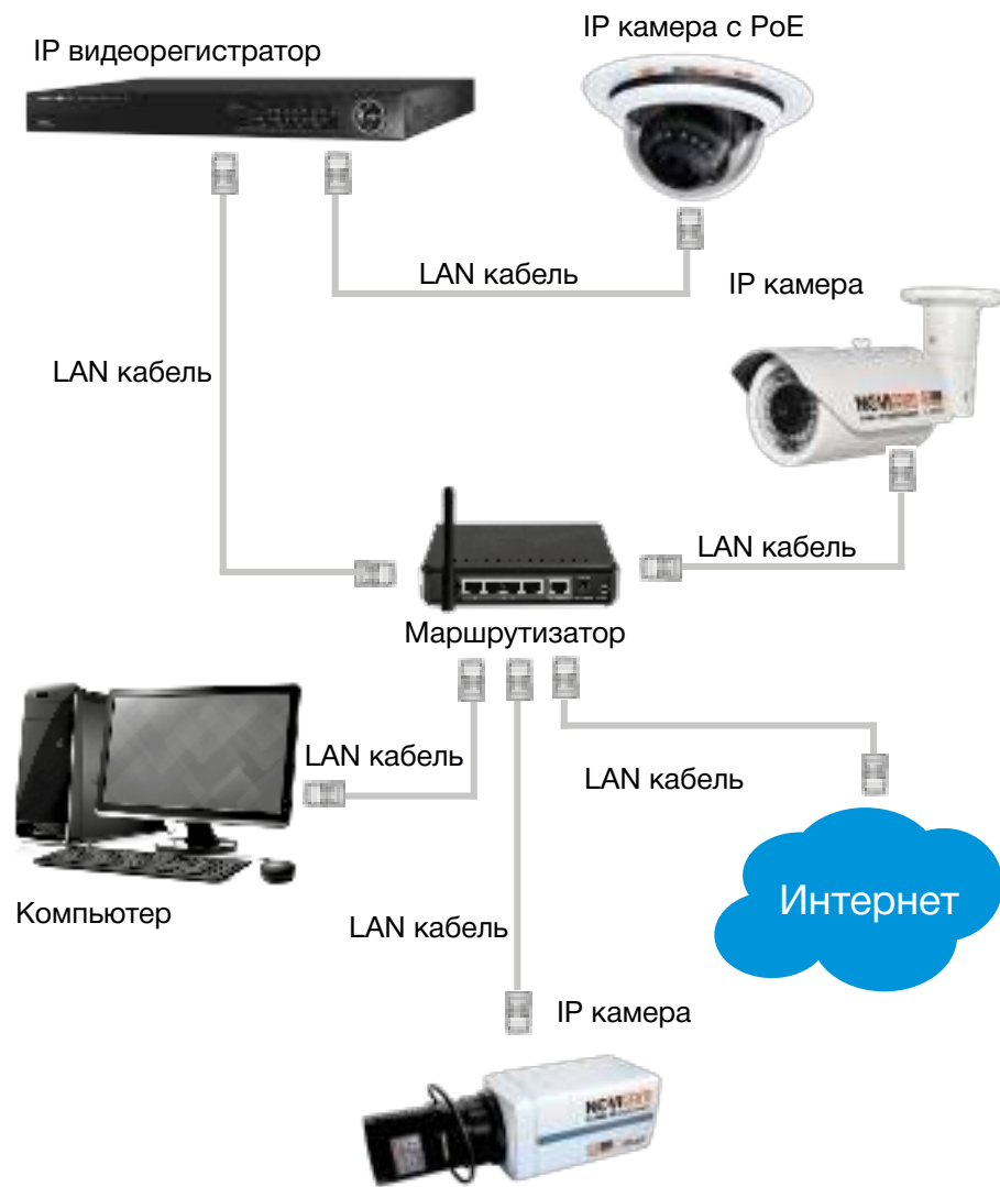
Рисунок 3.19 Подключение IP видеорегистратора с PoE.
