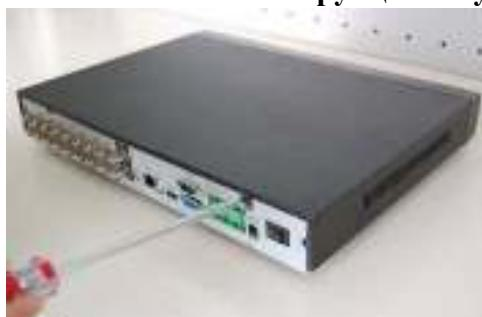
Открутите винты крепления крышки на нижней части корпуса.
