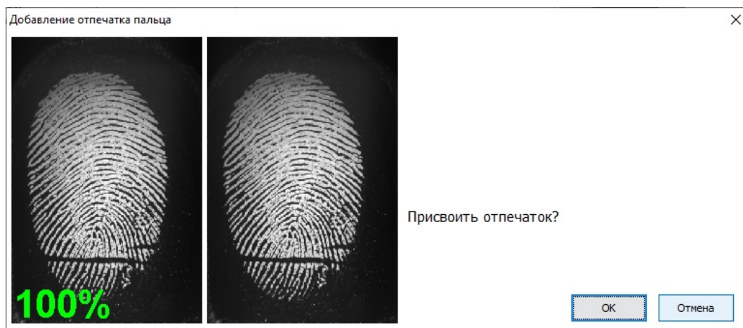
Пример сканирования отпечатка пальца с помощью BioSmart FS80.
