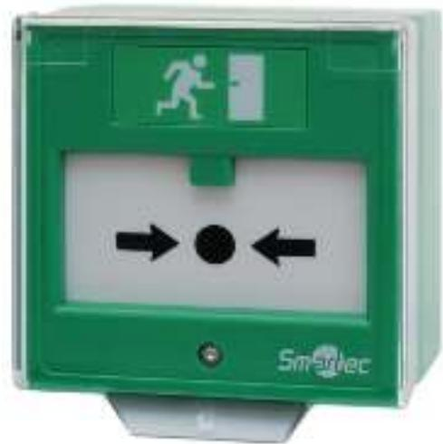
Устройство разблокировки дверей (УРД) ST-ER125D-GN рекомендуется к использованию для разблокировки электрически управляемых замков в экстренных случаях с внутренней стороны на выход, например, при эвакуации людей. Восстанавливаемая кнопка активации позволяет быстро и без дополнительных расходов (замена при использовании стеклянных вставок) восстановить нормальный режим эксплуатации дверей после осуществления эвакуации.
