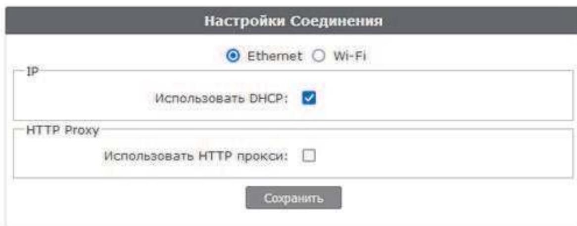
В случае использования в локальной сети DHCP-сервера сетевые настройки получаются контроллером автоматически.
