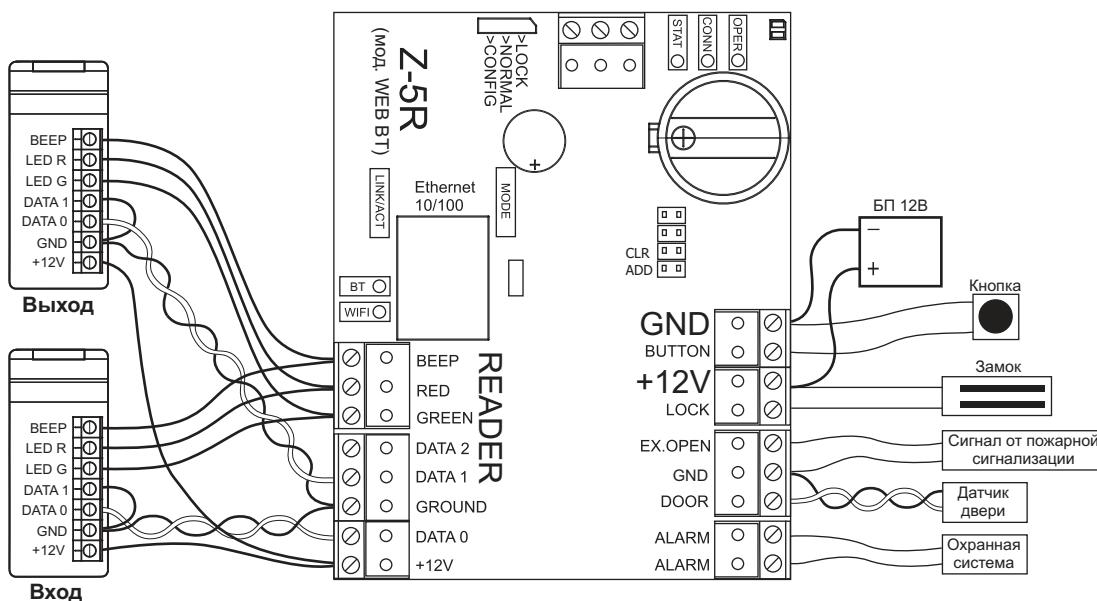
Подключение внешних считывателей по протоколу Wiegand:
