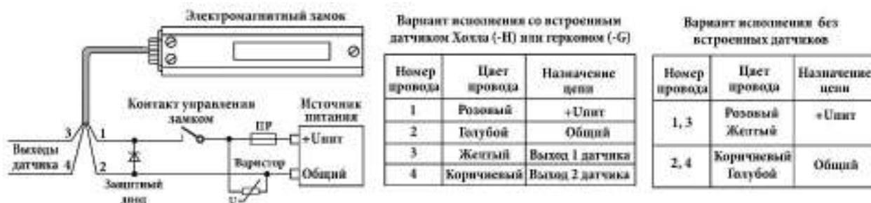
Рисунок 9 - Схема подключения замка
