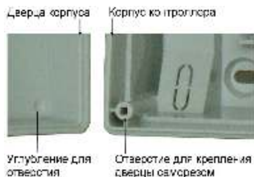
Рисунок 8. Схема «жесткого» крепления дверцы к корпусу контроллера
