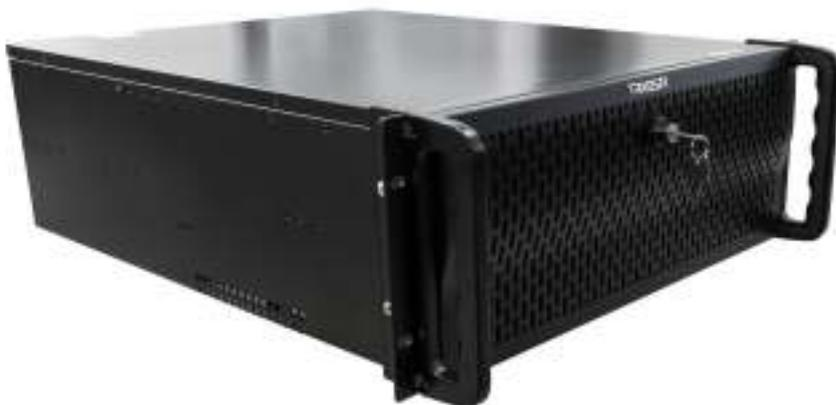
**TRASSIR NeuroStation Pro** – сетевой видеорегистратор для IP-видеокамер под управлением TRASSIR OS (Linux) с поддержкой видеоналиктики на основе нейронных сетей: детекция проникновения людей в зону, подсчет количества людей в зоне (например, в очереди), а также поиск в архиве по людям. Поддержка Offload-аналитики (прием и обработка изображений передаваемых с других серверов TRASSIR).
