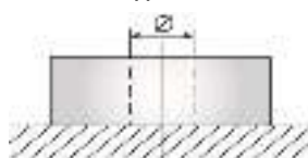
Тип клемм под болт М8
