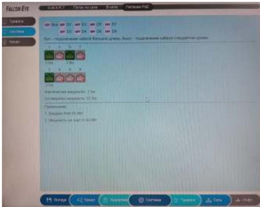
В режиме «**Extended PoE**» пропускная способность канала ограничена в пределах 5 Мбит/с. Не используйте этот режим при стандартных расстояниях передачи (до 100 метров).
