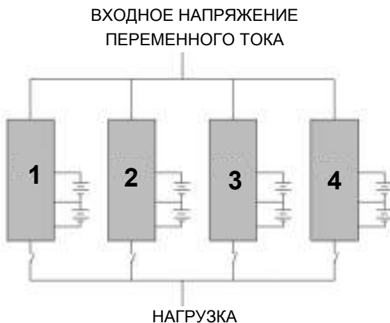
Рисунок 25 — схема подключения изделий в систему параллельного резервирования.
