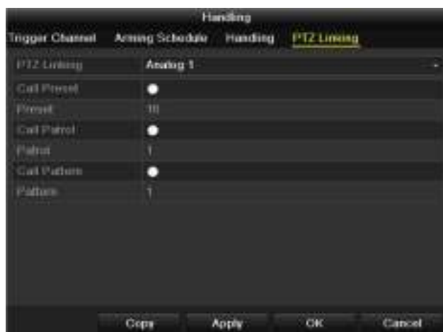
Рисунок 8.9 Установка PTZ привязки тревожного входа
