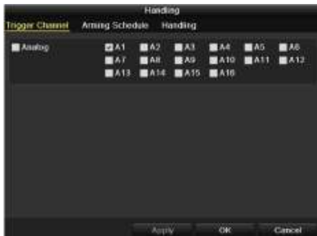
Рисунок 8.3 Установка камер, реагирующих на тревогу
