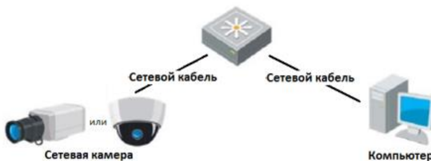
Рисунок 2-2 Подключение через коммутатор или роутер
