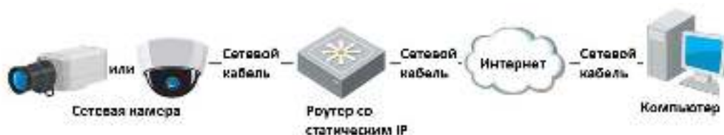
Рисунок 2-10 Доступ к видеокамере через роутер со статическим IP-адресом
