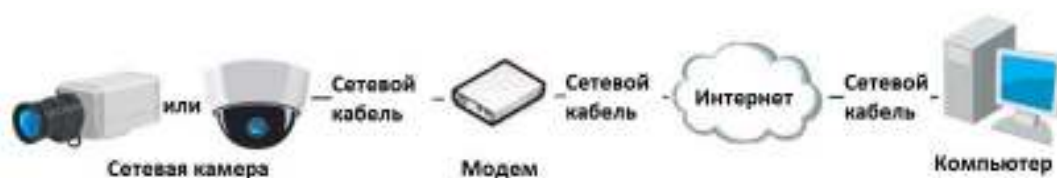
Рисунок 2-12 Доступ к видеокamере с динамическим IP-адресом
