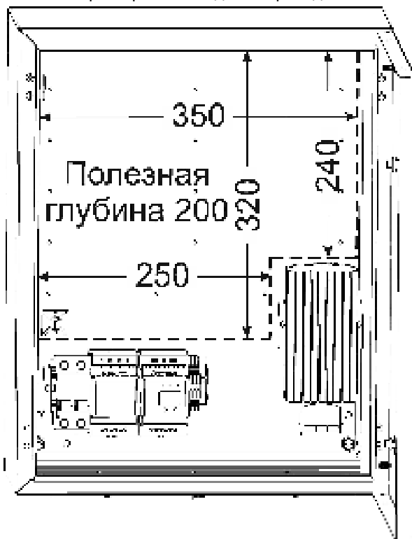
Рисунок 1 – Пространство внутри для установки доп. оборудования
