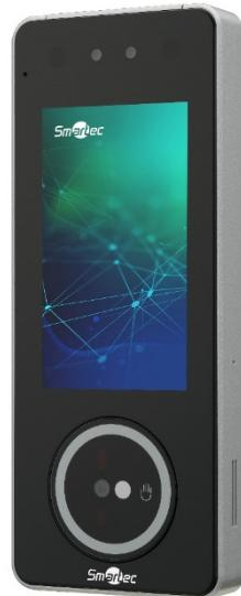
Биометрический считыватель ST-BR341P предназначен для идентификации по ладони и используется в системах контроля доступа и учета рабочего времени. Устройство поддерживает следующие режимы идентификации пользователя: по ладони, по цифровому коду или их комбинация.
