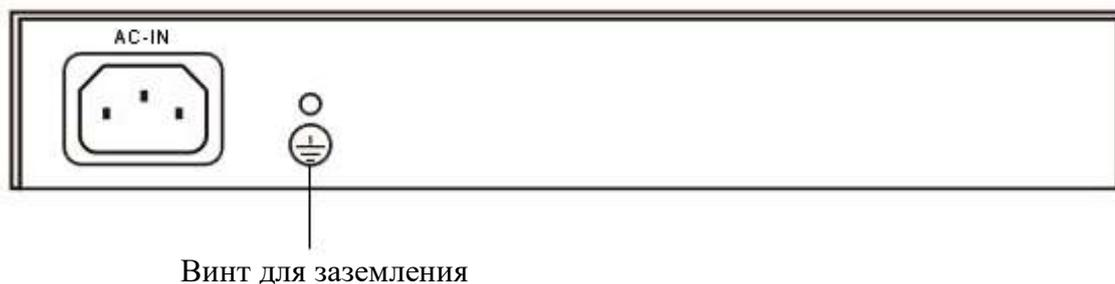
Рисунок 2 Задняя панель коммутатора
