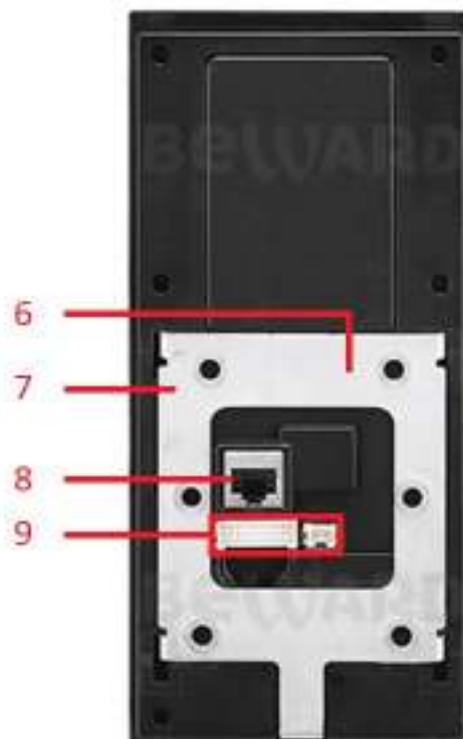
**6 – датчик вскрытия корпуса:** устройство, обеспечивающее оповещение при несанкционированной попытке снятия устройства во время работы (находится под крепежной пластиной).
