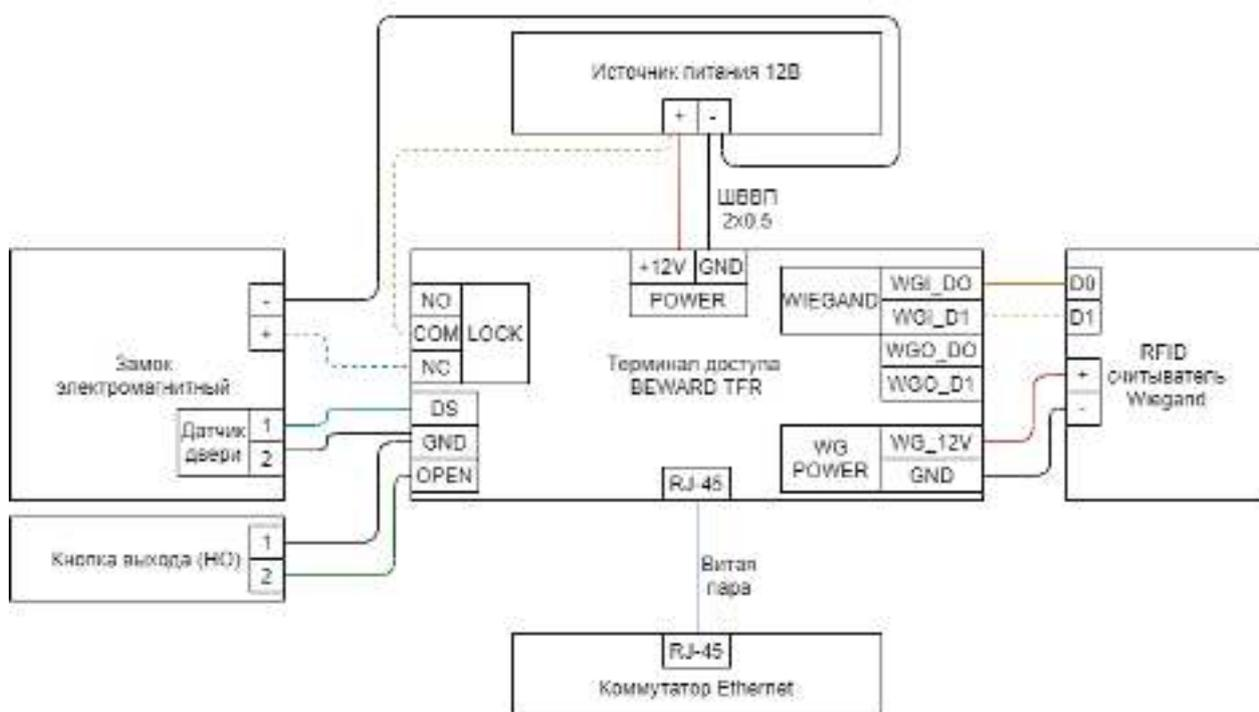
Подключение RFID считывателя на Wiegand вход выполняется опционально, и служит для обеспечения идентификации по основному или дополнительному признаку «Карта».
