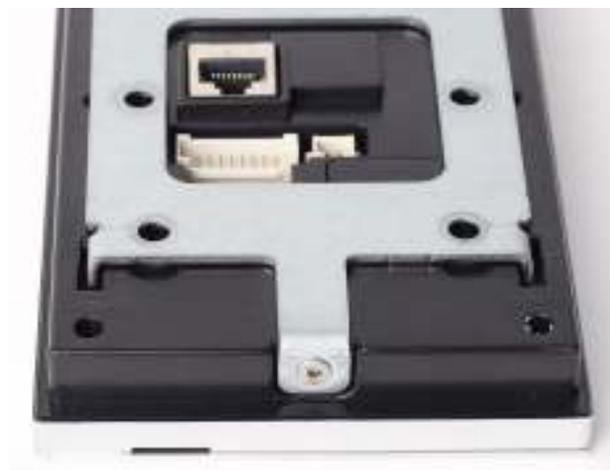
Для выкручивания болта используйте ключ из комплекта поставки. Рекомендуемая высота установки монтажной пластины на вертикальную поверхность составляет 1,4 метра от уровня пола до начала монтажной пластины.
