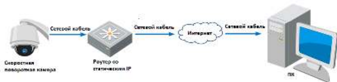
Рисунок 1-10 Доступ к камере через роутер со статическим IP-адресом
