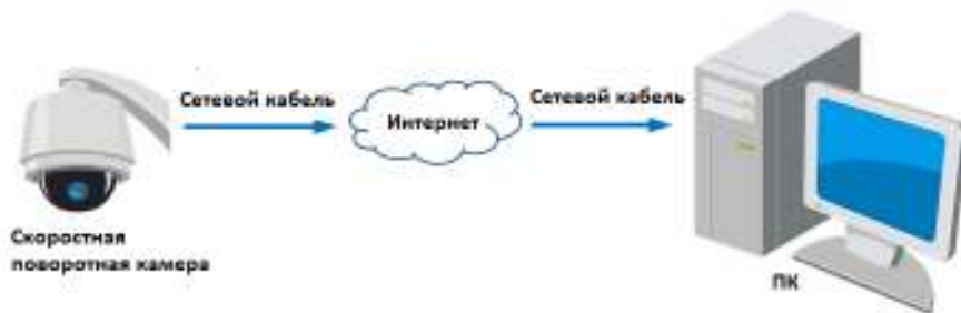
Рисунок 1-11 Доступ напрямую к камере со статическим IP-адресом
