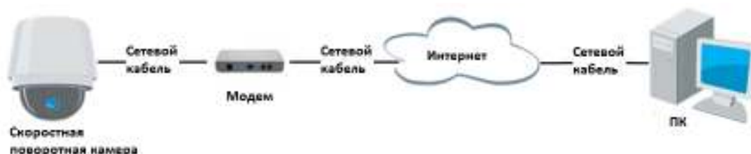
Рисунок 1-12 Доступ к камере с динамическим IP-адресом
