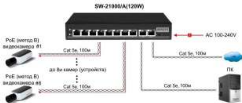
Рис.4 Типовая схема подключения коммутатора SW-21000/A(120W)
