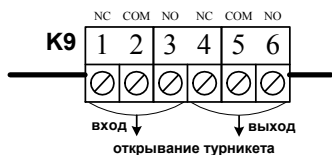
Пример 5. Подключение турникета (турникетный режим)
