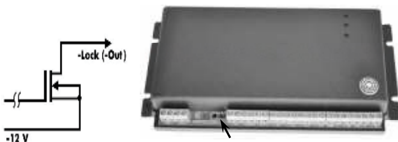
Рисунок 5 – Схема входных каскадов “Inx”
