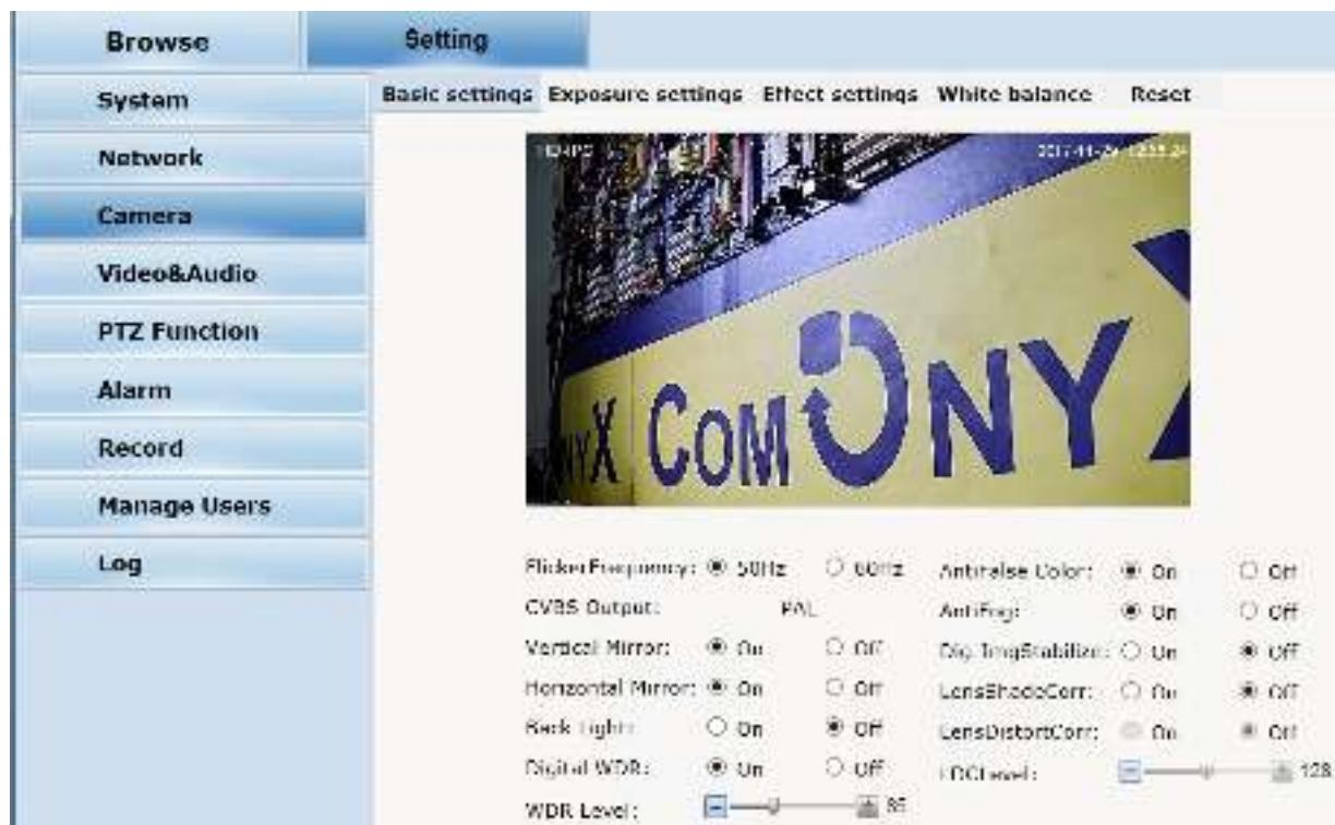
**FlickerFrequency:** частота сети - 50HZ, 60HZ.
