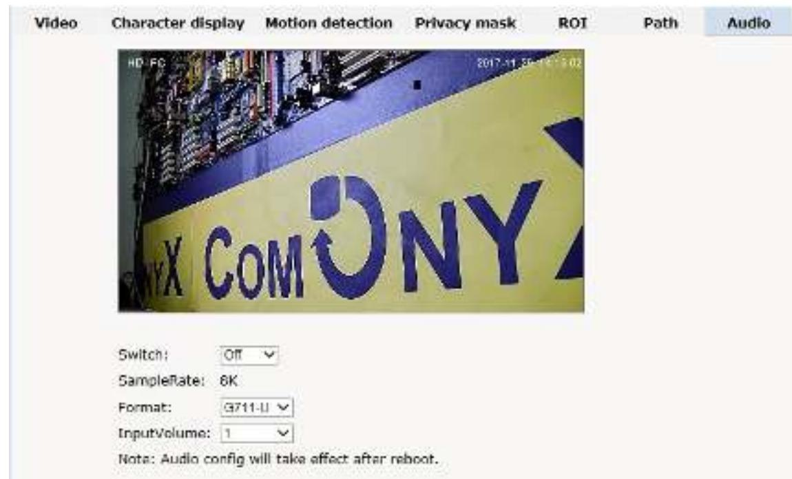
Для передачи аудиопотока необходимо его включить и выбрать стандарт сжатия звукового потока и уровень входного сигнала (Опционально).
