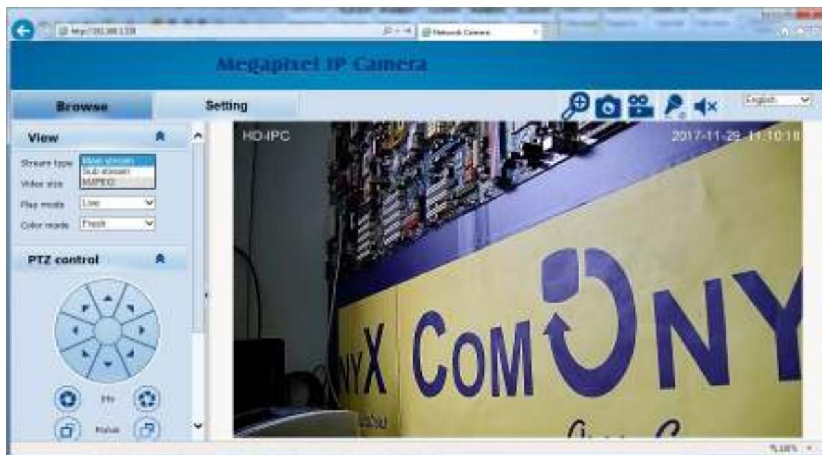
Интерфейс камеры содержит две основные вкладки – **Browse** (Режим просмотра и управления камерой) и **Setting**(Режим настроек).
