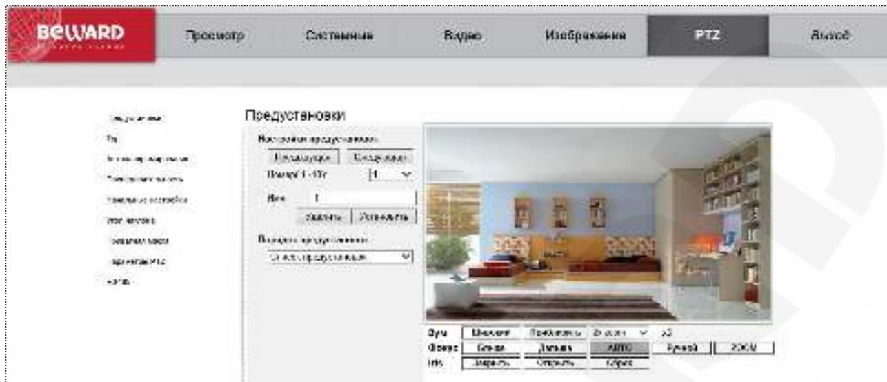
Для запоминания предустановок выберите номер ячейки, задайте имя, в окне отображения видео выставьте положение с помощью элементов управления и нажатия и удержания левой кнопки мышки, нажмите кнопку «Установить».
