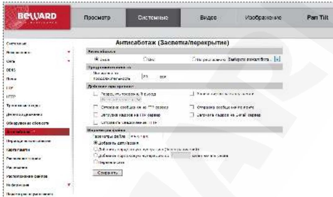
Под вмешательством понимаются действия, направленные на изменение направления наблюдения, закрытие объектива камеры предметом, засветка объектива камеры и т.п. Обнаружение вмешательства происходит благодаря анализу видеозображения за заданный период времени.
