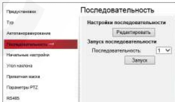
Для просмотра заданной последовательности выберите в разделе «Запуск последовательности» номер последовательности и нажмите кнопку «Запуск».
