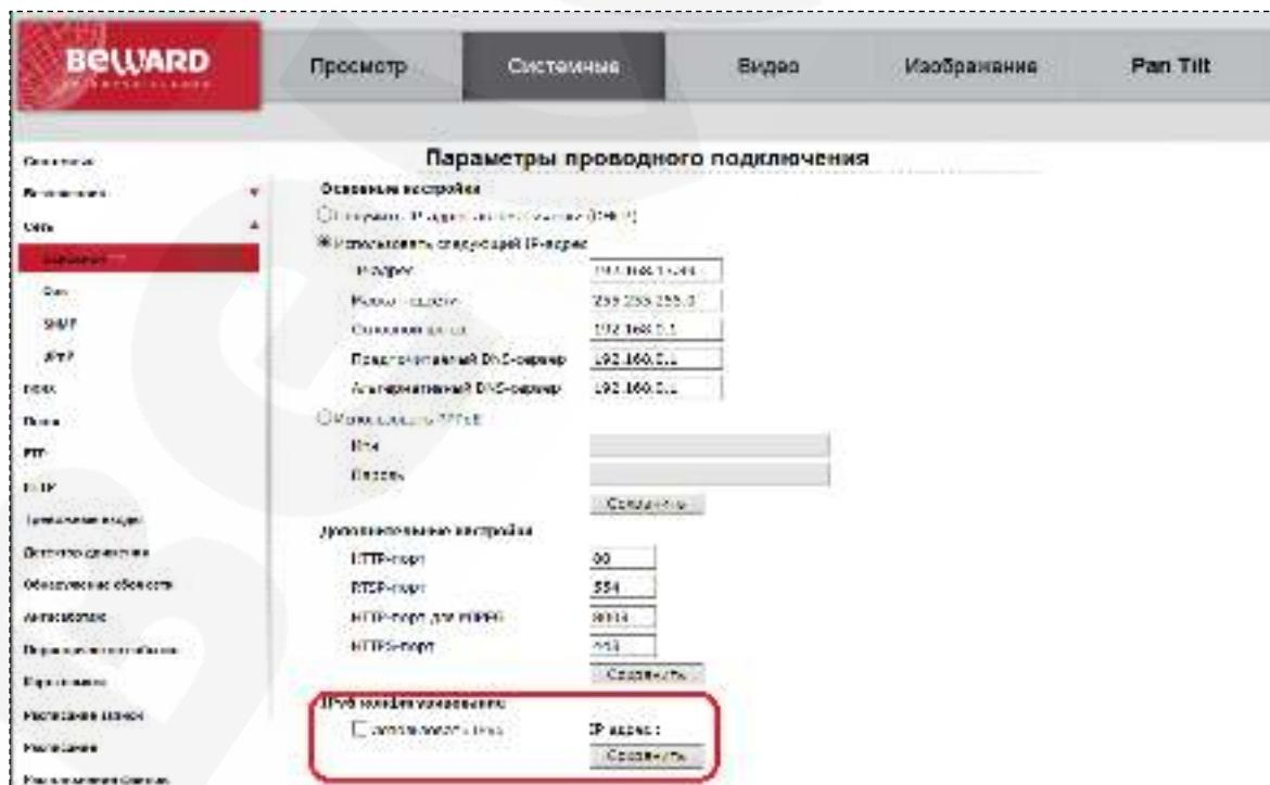
Если необходимо включить поддержку протокола IP версии 6, установите галочку напротив строки [Использовать IPv6 (Enable IPv6)].
