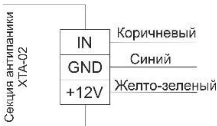
Рисунок 8.1 Назначение проводов секции Антипаника «ХТА-02»
