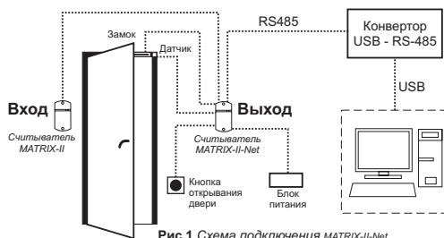
Рис.1 Схема подключения MATRIX-II-Net.
