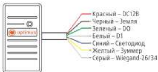
Рисунок 1. Цветовая маркировка проводов
