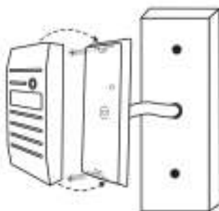
Рисунок 2. Способ настенного монтажа
