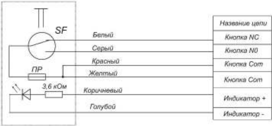
Рисунок 2 – Маркировка выводов изделия AL-BT-S03
