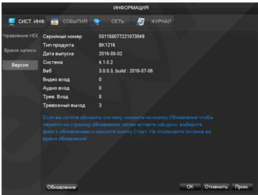
**[Версия]** Отображается версия программного и аппаратного обеспечения видеорегистратора.
