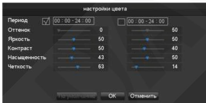
**[Период]** Могут быть установлены два временных периода, для переключения цветов в зависимости от окружающего освещения.
