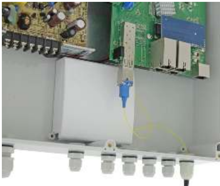
Рис. 5 Коммутатор SW-40501/WC с смонтированным оптическим кроссом (SFP-модуль в комплект поставки не входит)
