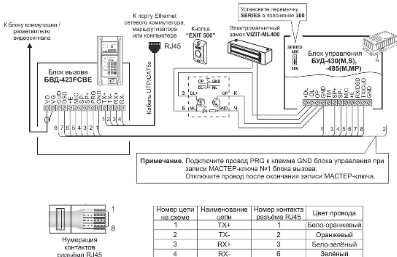
Рисунок 8.2 – Схема соединений блока вызова БВД-423FCBE с блоком управления БУД-430(M,S), -485(M,MP), электромагнитным замком VIZIT-ML400 и кнопкой EXIT 500
