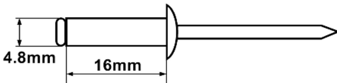
*Рисунок 1-чертеж заклепки*
