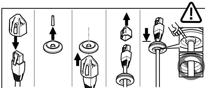
4. Слегка потяните сетевой кабель назад, чтобы кабельный сальник закрепился на кабеле.
