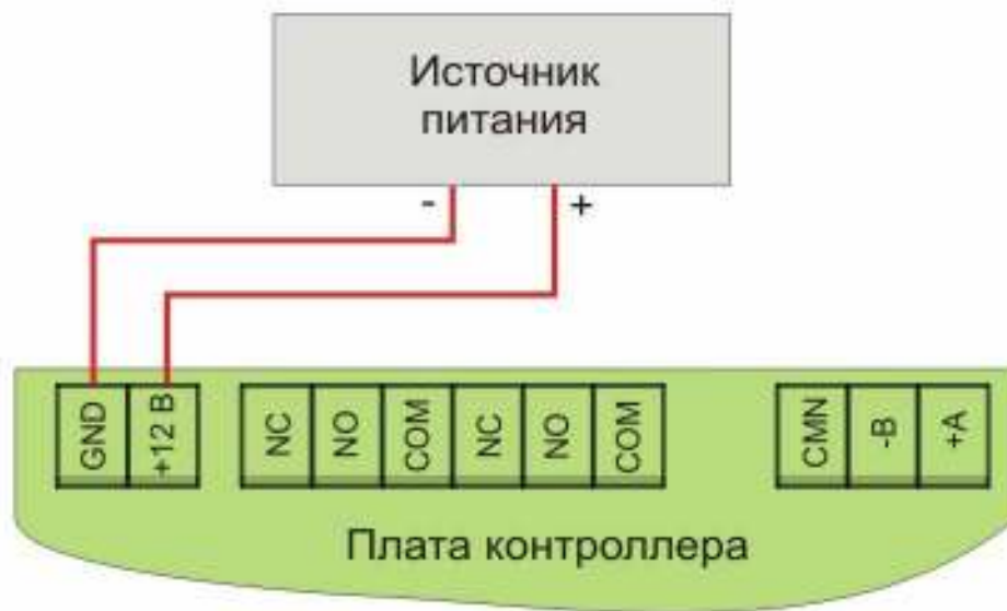
Рисунок 2. Подключение источника питания к контроллеру.
