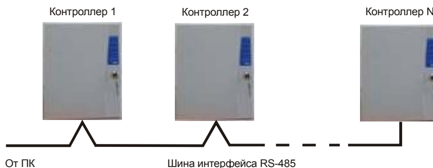
а). Соединение контроллеров по топологии «Шина».
