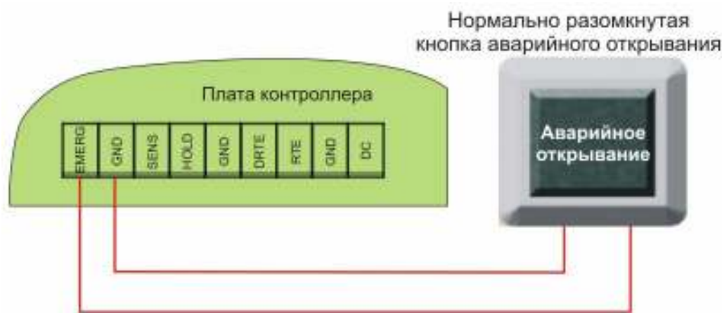
Рисунок 14. Подключение аварийной кнопки к одному контроллеру.
