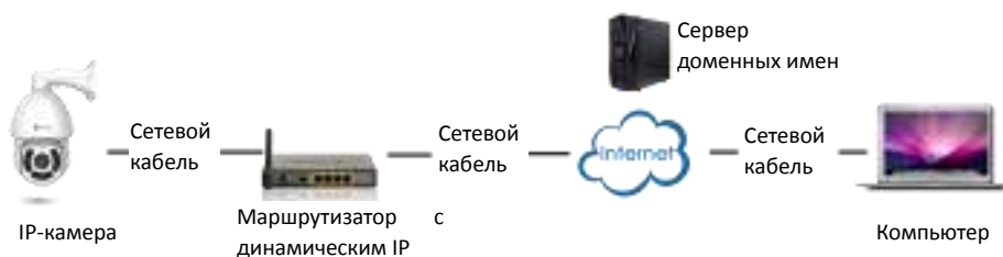
Рис. 2-2. Подключение сетевой камеры через маршрутизатор, используя динамический IP-адрес.
