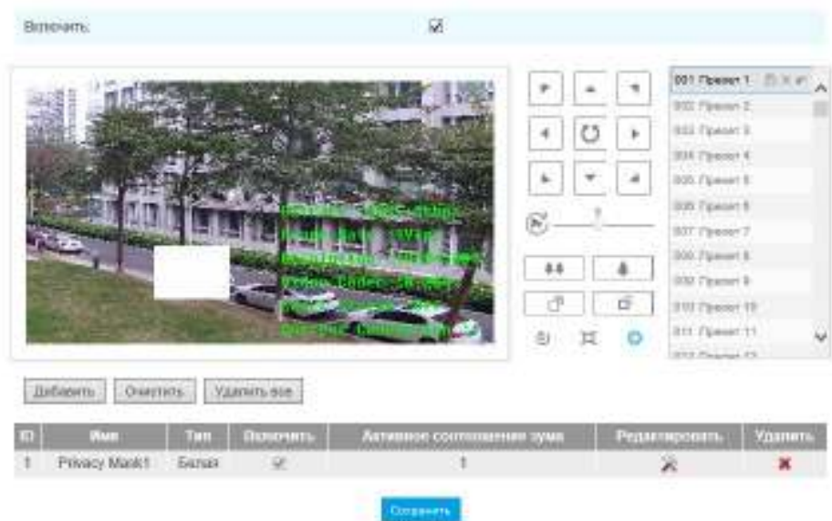
Рис. 4-3-39 Маскирование частных зон
