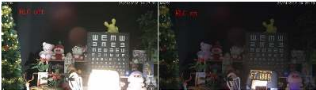
Рис. 4-3-9 Компенсация бликов света
