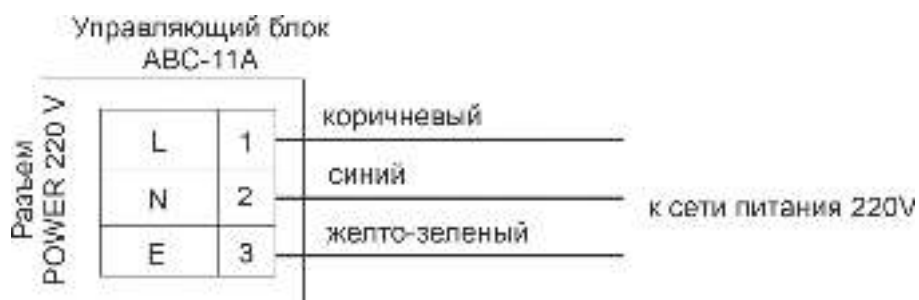
Рисунок 7.4.2 Схема подключения питания к управляющему блоку
