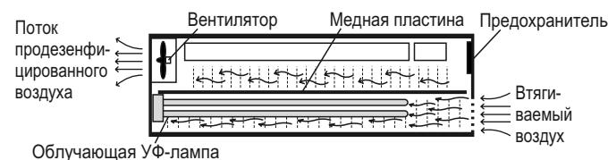
Рисунок 1 — Принцип работы рециркулятора
