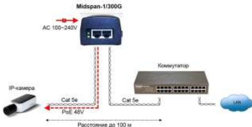
Рис. 3. Схема подключения инжектора Midspan-1/300G
