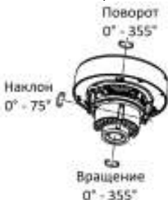
Рисунок 2.15 3-х осевая регулировка объектива
