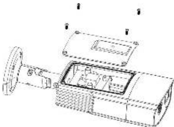
Шаг 1: Ослабьте винты с помощью отвертки
