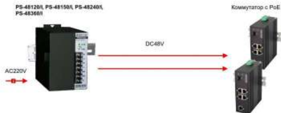
Рис. 8 Подключение PS-48120/I, PS-48150/I, PS-48240/I, PS-48360/I
