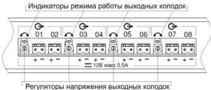
Рисунок 2 - Увеличенное изображение выходных колодок ПН.
