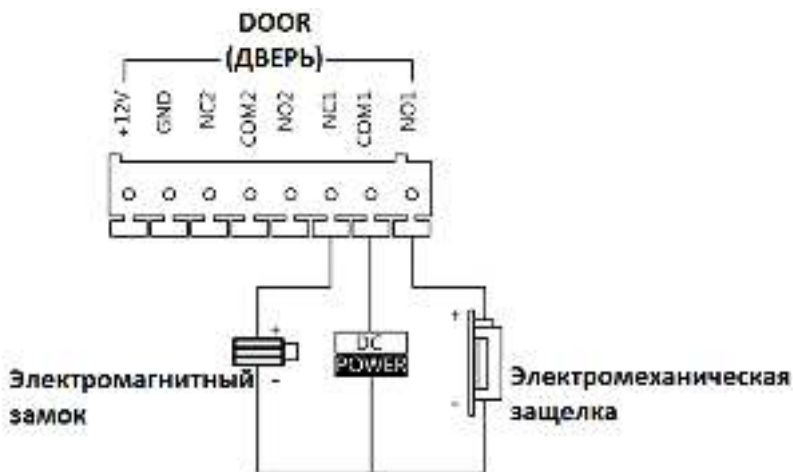
Рисунок 5-16 Подключение дверного замка
