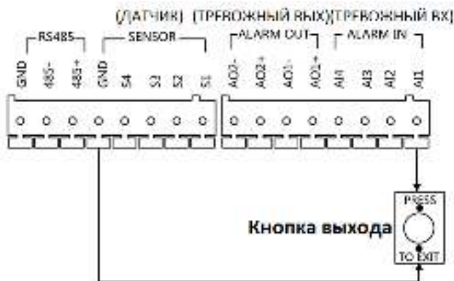
Рисунок 5-20 Подключение кнопки выхода для моделей DS-KD8102-V/DS-KD8002-VM (1)
