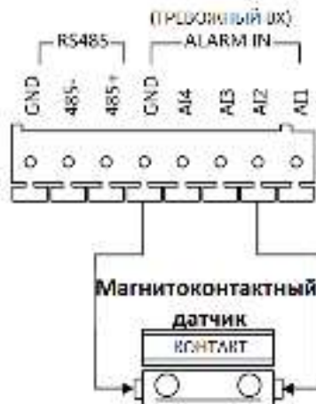
Рисунок 5-19 Подключение магнитоконтактного датчика для модели DS-KD6002-VM
