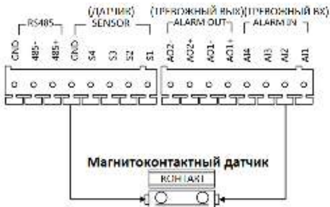
Рисунок 5-17 Подключение магнитоконтактного датчика для моделей DS-KD8102-V/DS-KD8002-VM (1)
